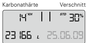
Gesamtzählerstand beim Austausch der Filterkartusche
